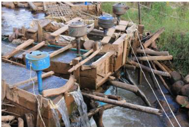
รูปที่ ๕ ฉางเพื่อผลิตไฟฟ้า
